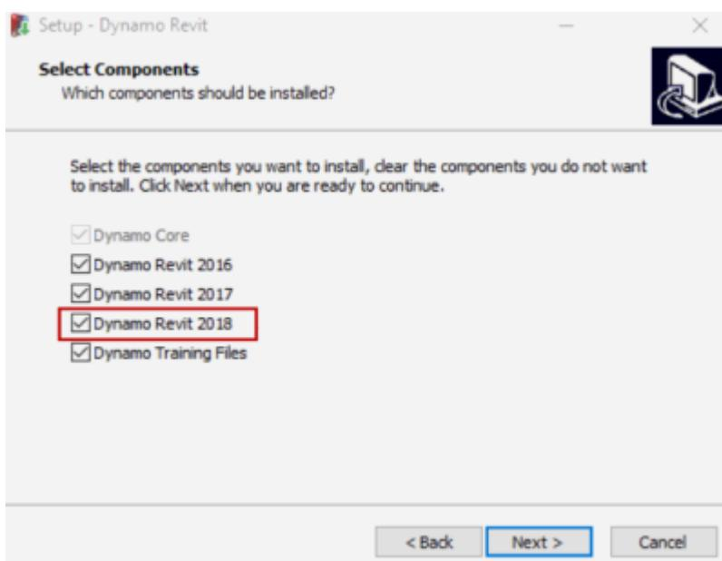
Nach der Installation befindet sich im Revit unter dem Tab „Verwalten“ ein Unterpunkt „Visuelle Programmierung“. Oft ist Dynamo schon vorinstalliert, jedoch in einer älteren Version, welche problemlos mit der neusten Version ersetzt werden sollte.
