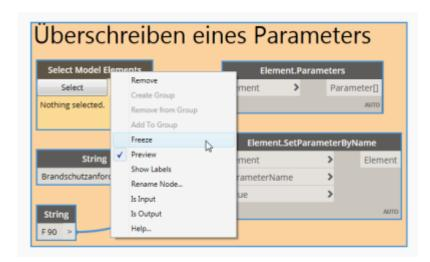
Der Select Model Elements und die beiden String Blöcke werden nun als Is Input definiert. Das untenstehende Teilskript wird gelöscht. Anschließend wird gespeichert.
