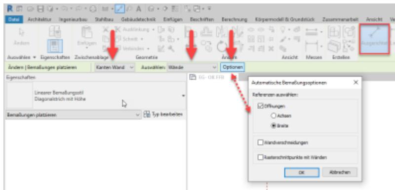
Ausgerichtete Bemassungen können zwischen zwei oder parallelen *Referenzen* oder *Wänden* erstellt werden. In der Optionsleiste stehen verschiedene Refenzelemente zur Verfügung
