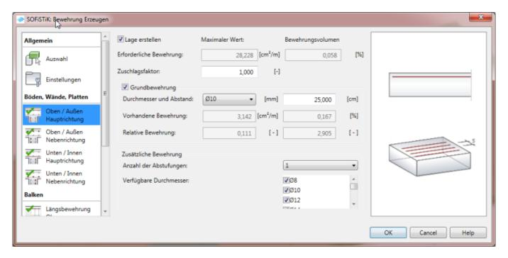
Im zugehörigen Bewehrungsplan wird die erzeugte Stabstahlverlegung sichtbar und kann überarbeitet werden.
