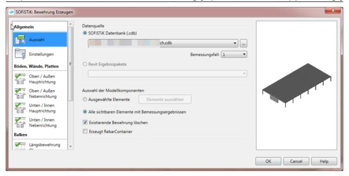
Durch aktivieren einer Bewehrungslage in der linken Dialogfensterhälfte kann für diese die zu verwendenden Stabquerschnitte vordefiniert werden.
