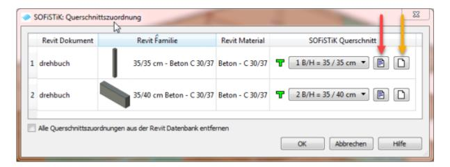
Über diesen Dialog können die in Revit verwendeten Querschnitte SOFiSTiK Querschnitten zugeordnet werden. Der rote Pfeil zeigt den Weg um den aktuellen Querschnitt aus der SOFiSTiK Datenbank anzupassen. Der orange Pfeil zeigt den Weg einen neuen SOFiSTiK Querschnitt zu definieren.
