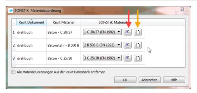
Über diesen Dialog können die in Revit verwendeten Materialien SOFiSTiK Materialien zugeordnet werden. In der SOFiSTiK Material Datenbank sind für genormte Materialien die notwendigen Kennwerte hinterlegt. Der rote Pfeil zeigt den Weg um ein anderes Material aus der SOFiSTiK Datenbank auszuwählen. Der orange Pfeil zeigt den Weg um auf Basis der SOFiSTiK Material Datenbank ein neues Material zu definieren.
