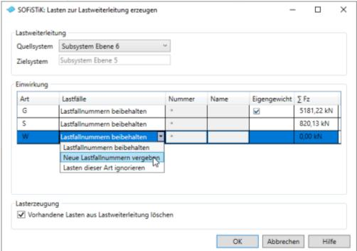
Zur besseren Übersicht bei der Auswertung können neue LF-Nr. vergeben werden Werden alle Lastfälle aus Lasten dieser Art ignorieren gesetzt und der Haken Vorhandene Lasten aus Lastweiterleitung löschen gesetzt können alle Übernahmen entfernt werden.
