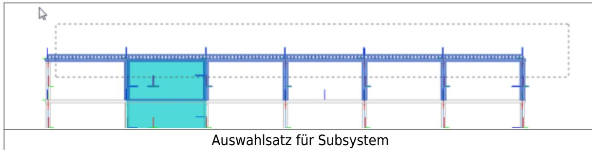
Nachdem das Subsystem angelegt ist müssen in der Ansicht nicht benötigte Bauteile und Einwirkungen ausgeblendet werden. Von der Decke und ggf. Trägern müssen die Schalkanten sichtbar sein. Unterstützungen wie Stützen und Wände werden ausschließlich durch die analytischen Achsen repräsentiert.
