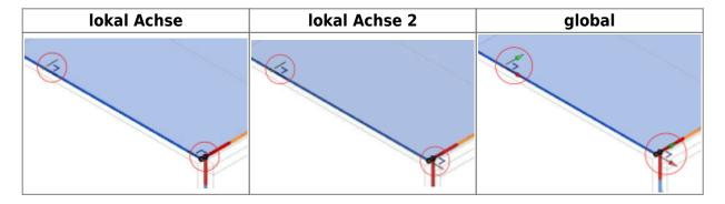
Das Berechnungsmodell kann nunmehr mittels der linken Maustaste verändert werden sodass die Knoten zusammenfallen.
